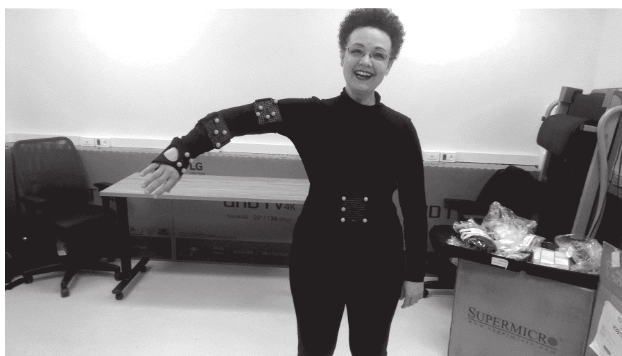
Figura 3: Posicionamento dos marcadores reflexivos.
